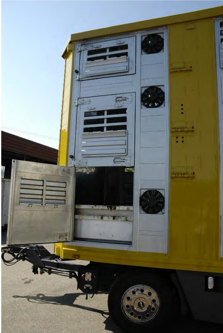
Bei der Verwendung von Hubböden muss für jede mögliche Ladeetage die Ventilation sicher gestellt sein (z.B. kein Verdecken der Ventilatoren durch den Boden).
