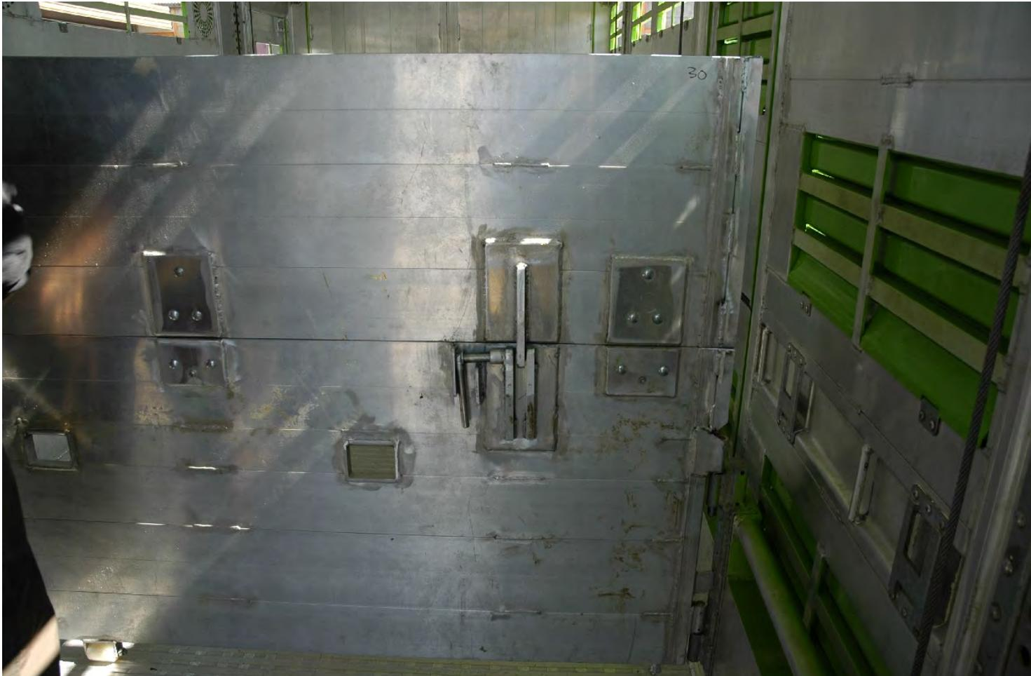
Trennwände müssen ausreichend hoch sein. Diese Trennwand kann der transportierten Tierart und Anzahl der Ladeetagen angepasst werden.
