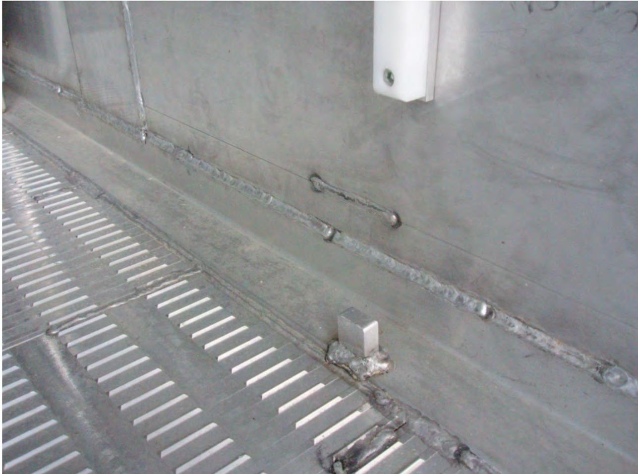
Riffelung bietet keine seitliche Rutschfestigkeit. Durch die breiten Streifen ohne Riffelung ist der Boden nicht ausreichend rutschfest. Der Bolzen am Boden ist bei nicht geschlossener Trennwand verletzungsgefährlich.
