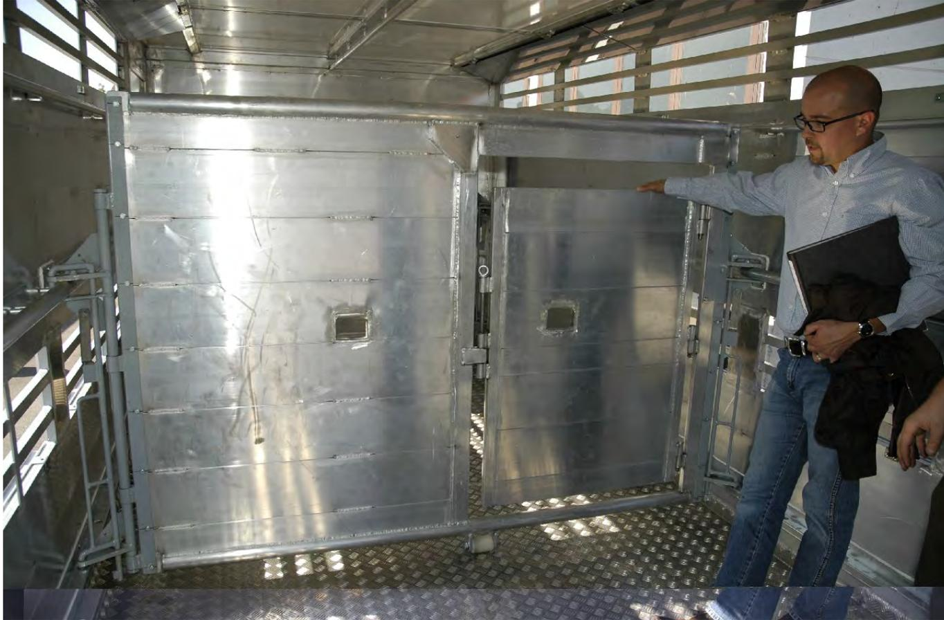
Durchgangstür ersetzt nicht die Zugangsmöglichkeit von außen
