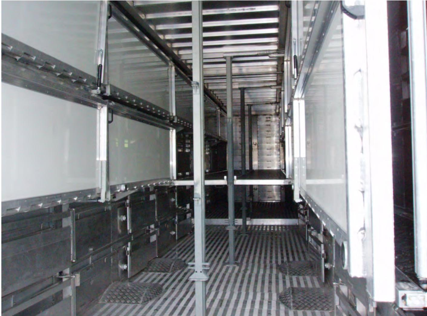
Klappböden: die Trennwände sind konstruktionsbedingt nicht verschieblich
