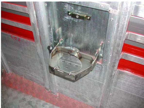
Hier ist eine Neukonstruktion der Fa. Pezzaioli dargestellt: diese Tränke ist für Rinder ungeeignet, da die Eintauchtiefe für das Flotzmaul für eine artgemäße Wasseraufnahme zu gering ist (mindestens 3 cm). Außerdem besteht trotz der Möglichkeit zum Wegklappen der Tränke (z.B. während der Verladung)
